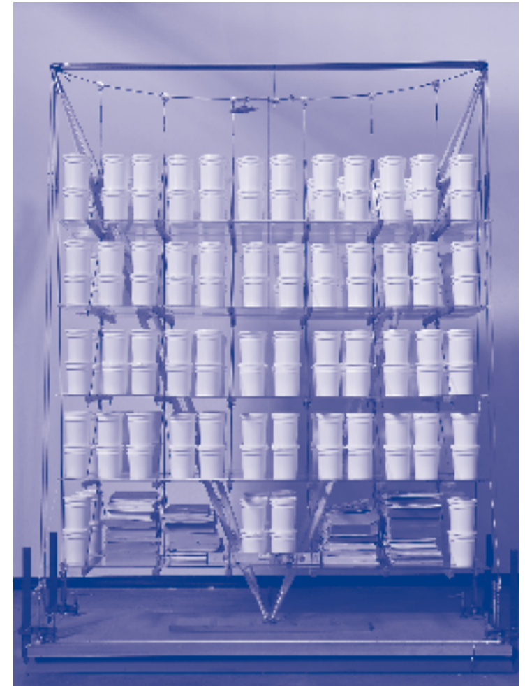
Prove di carico su un prototipo ricostruito da Cassina, dove viene anche utilizzata un'affusolata barra a sezione circolare posta in alto tra i due puntoni diagonali, come elemento utile a mantenere aperta la triangolazione delle forze. / Load-bearing tests on a prototype reconstructed by Cassina, where a tapered bar was positioned between the two diagonal bows to retain the triangular force.
